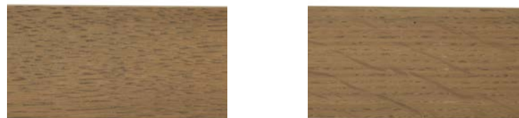
Exemples de différence de grain et d'aspect entre deux façades bois. Examples of difference in grain and appearance between two wood facades.
